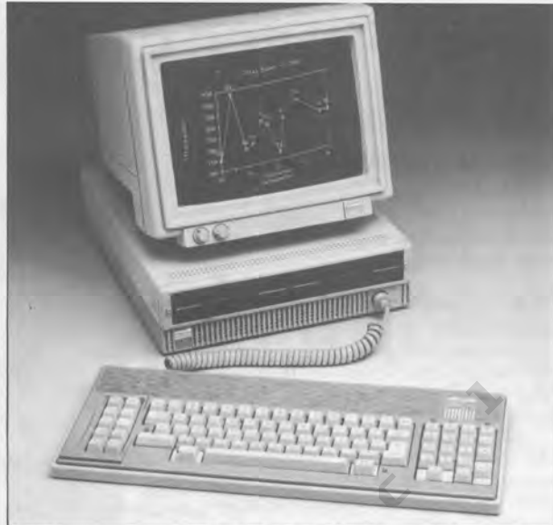
El Personal Computer M-19 de Olivetti tiene un disco duro de 20 MB y una mayor velocidad de acceso al sistema operativo. Está en exhibición en Panorama Bits Center.
